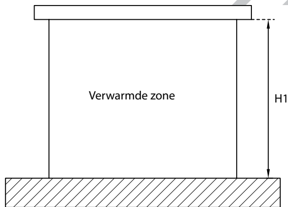
Afb. 6.5 Thermische schil grenst aan buitenlucht (H1). H1 is maaiveld tot aan dakconstructie
