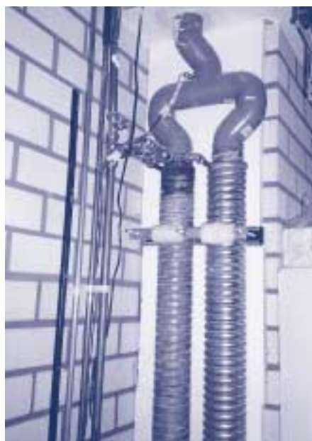
Prototype van een wtw voor douchewater.
